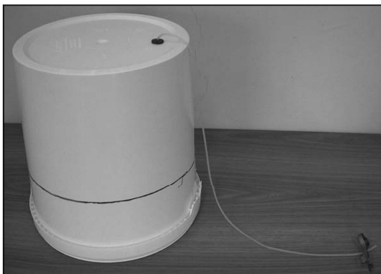
Рис. 34. Собранная конструкция для измерения эмиссии газов
