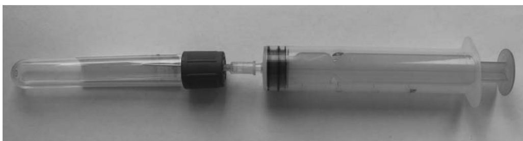
Рис. 31. Введение пробы воздуха в вакутейнер
