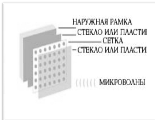
Рис. 4. Конструкция дверцы микроволновой печи
