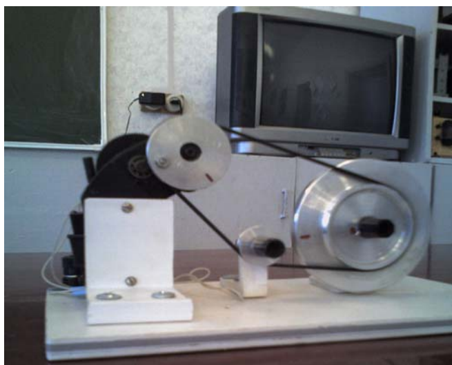
Рис. 2. Прибор для изучения кинематических схем
