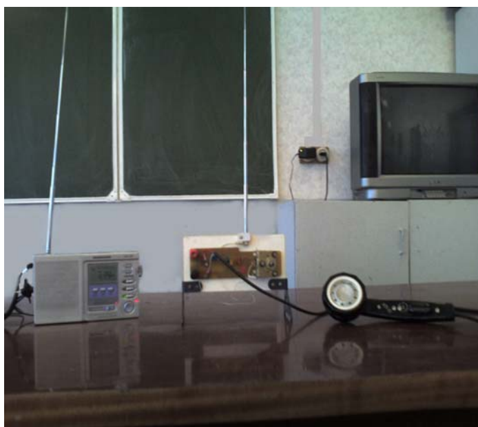
Рис. 4. Простейший УКВ передатчик на монтажной панели
