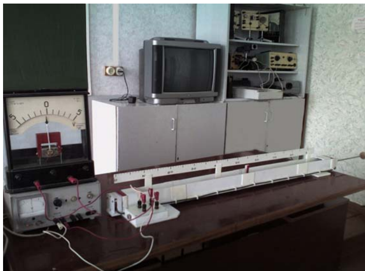
Рис.5. Прибор для определения скорости звука в воздухе
