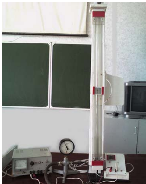
Рис. 6. Прибор для определения ускорения свободного падения
