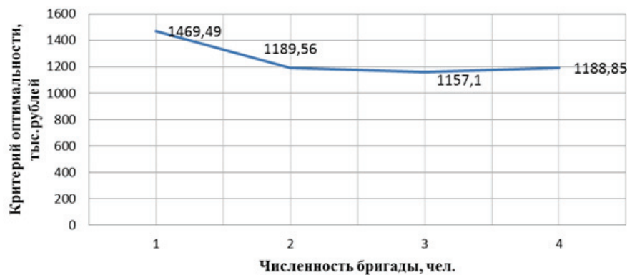
Рис. 1. Зависимость затрат на содержание ремонтного персонала и потерь, связанных с простоем технологического оборудования, от количества ремонтных бригад
