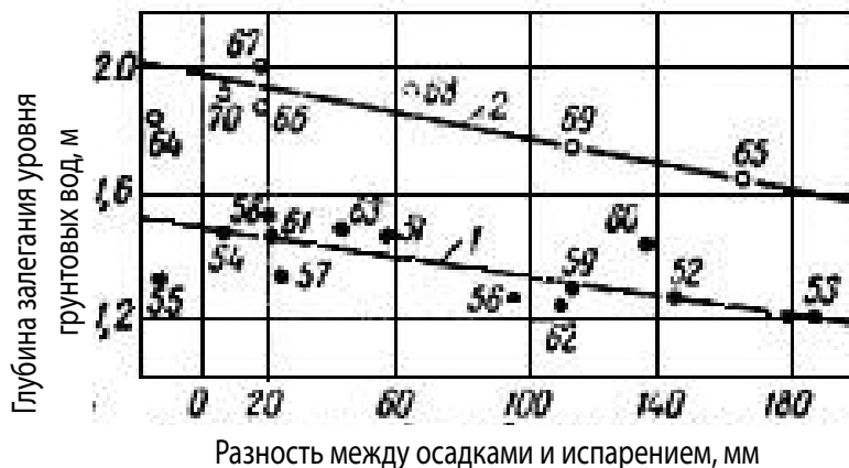
Рис. 32. Зависимость средних (за май–сентябрь) глубин залегания уровня грунтовых вод в скважине № 15 от разности между осадками и испарением: 1 – до осушения; 2 – после осушения
