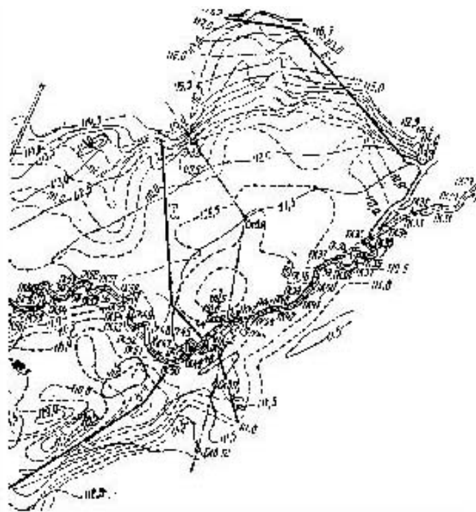
Рис. 127. План части пойменного болота р. Пехорки (от пикета 29 до ГК 62): 1 – горизонтали поверхности; 2 – горизонтали минерального дна болот; 3 – динамическая ось потока и пикеты по трассе реки; 4 – линии геологических разрезов и скважины; 5 – дороги
