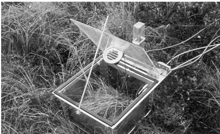
Рис. 14. Автоматическая камера для измерения потока CH_4 , (вариант 1997 г.) [66]
