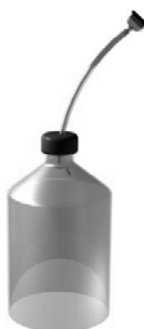
Рис.3 Простейшая камера, изготовленная из обычной пластиковой бутылки
