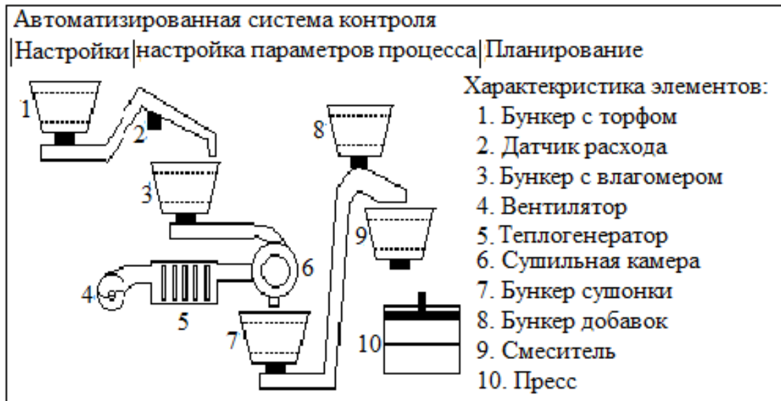
Рисунок 3. Интерфейс программы управления автоматической линией производства торфяных брикетов.
