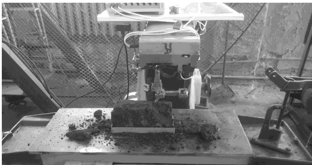
Рисунок 2. Размещение торфяного монолита на столе станка.
