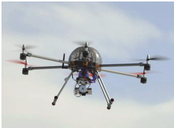
Фото 1. Экспериментальный гексакоптер с системой оптической стабилизации
