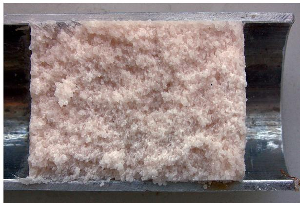
**Рис. 1.** Образец слежавшегося каучука после хранения в течение 30 суток
