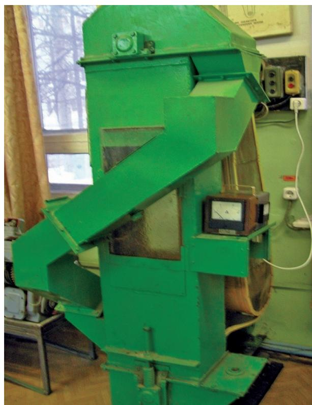
**Рис. 2.** Лабораторный вертикальный ковшовый элеватор
