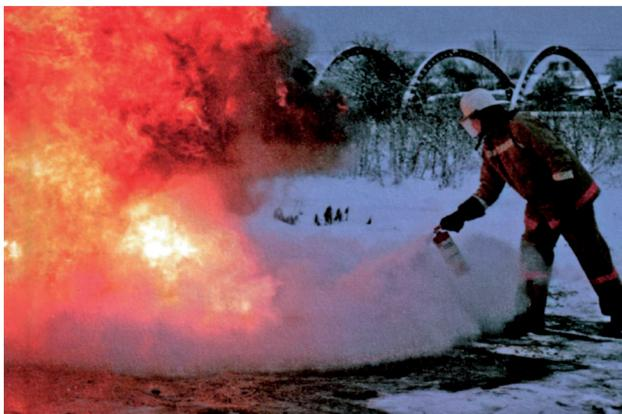
**Рис. 3.** Тушение модельного очага пожара (класс 55В) огнетушащим порошком на основе компонентов «Волгалит-АВС» и торфяного гидрофобизатора
